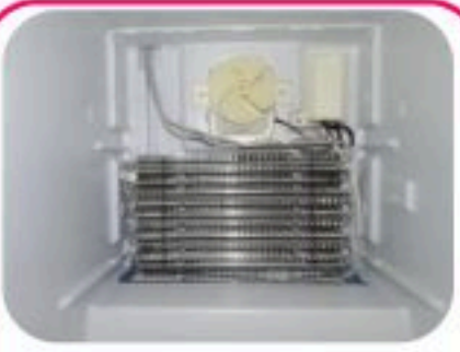
المبخّر ( الفريزر ) مبادل حراري داخلي
