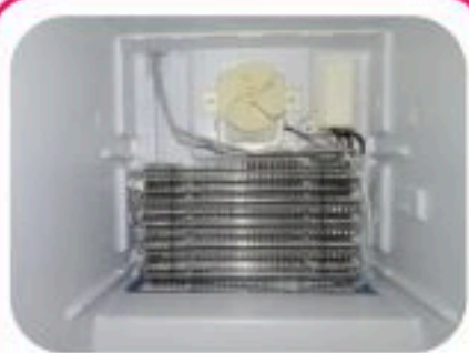
المبخر ( الفريزر ) مبادل حراري داخلي
