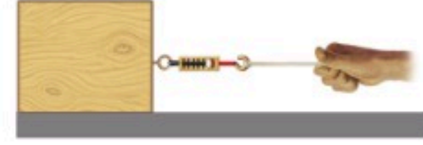
■ الشكل 5-9 يسحب الميزان النابضي الكتلة بقوة ثابتة.
