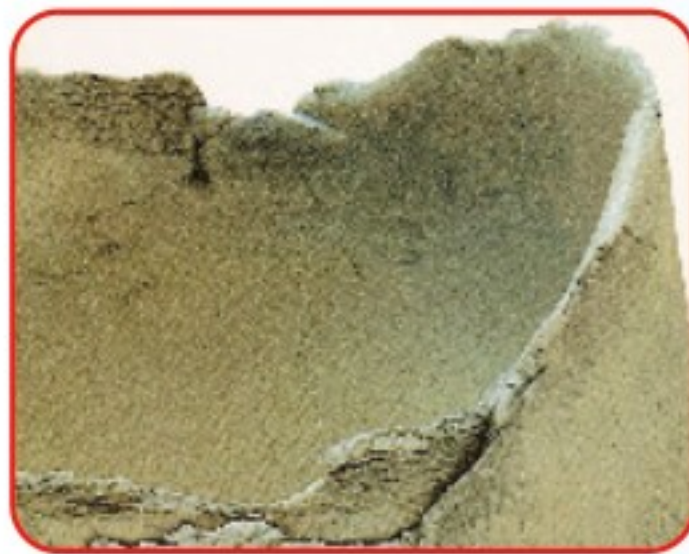
شكل ( ١٠٦ ) : يوضح نتائج أخطاء التجفيف ( تشقق ).
