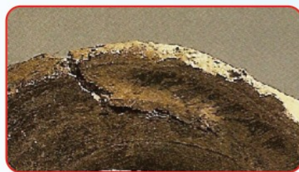
شكل ( ١٠٦ ) : يوضح نتائج أخطاء التجفيف ( تشقق ).
