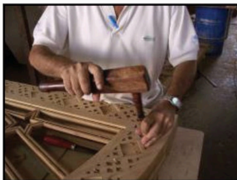
(١): استخدام المدق الخشبي، وهي الأداة الصحيحة.
