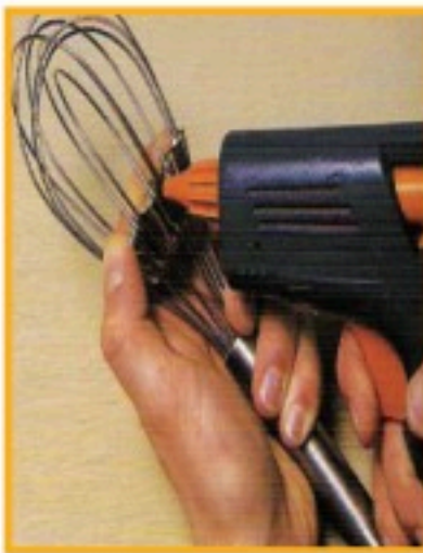
الشكل (٩٢): النوع الثاني ( لحام البارد باستخدام الصمغ ) .
