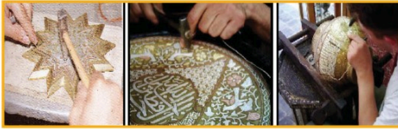
الشكل (٨١): طريقة التكفيت
