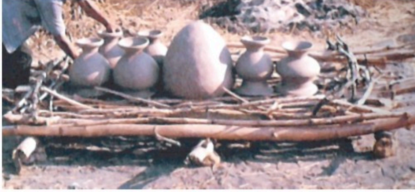
الشكل ( ٣٦ ) : الطريقة التقليدية لتجفيف البطانات .
