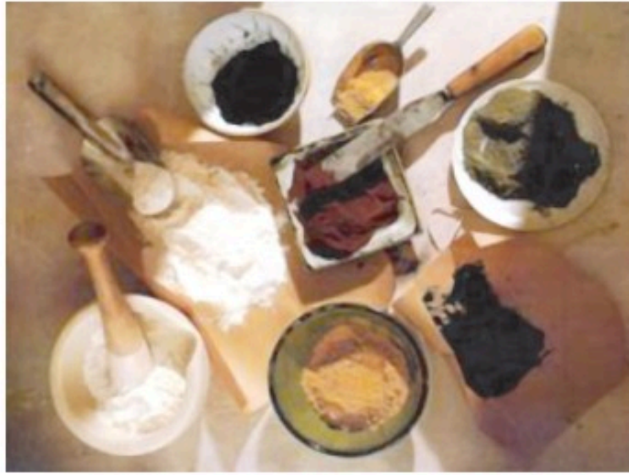
الشكل (٢٧): بعض الأكاسيد الملونة بعد طحنها.
