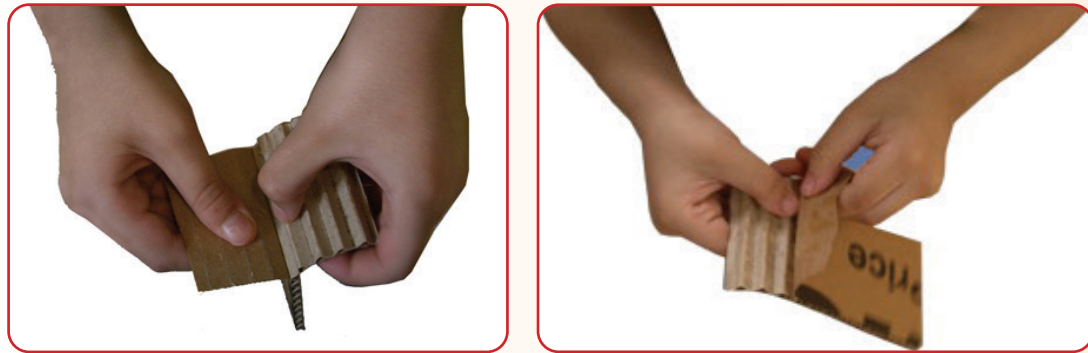
شكل (٢٣): طريقة فك طبقة من الكرتون.
