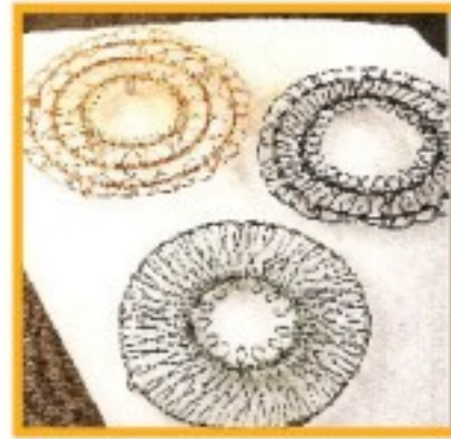
الشكل (٤٠): أسلاك رفيعة للربط
