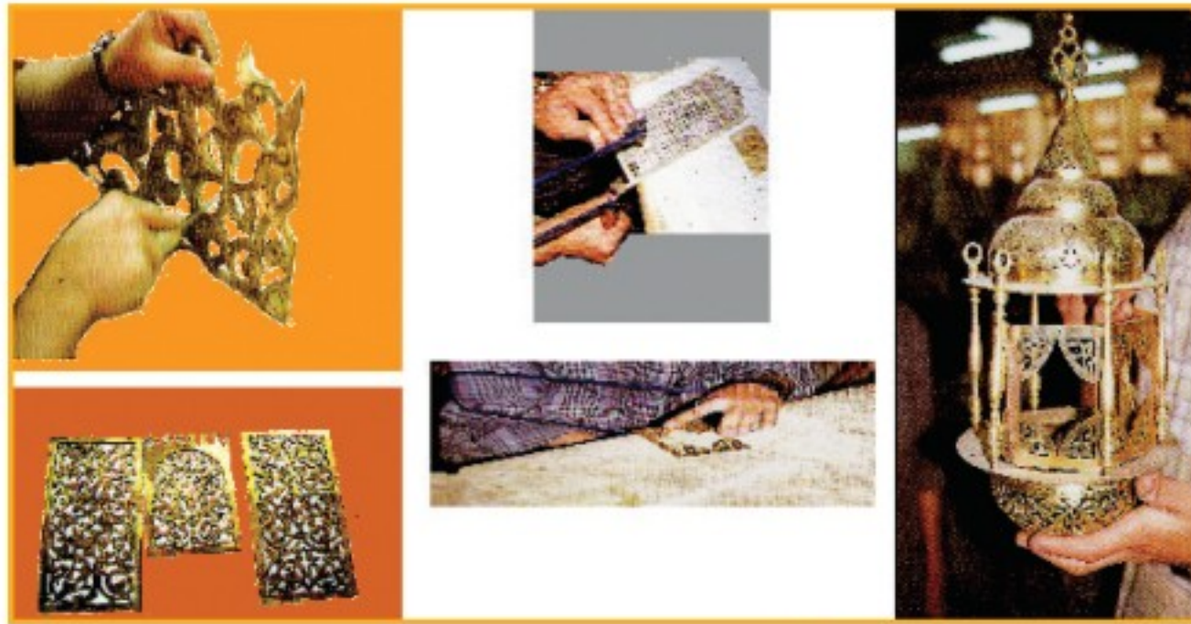
الشكل (٨)، طرق استخدام أزاميل ومنشار المعادن
