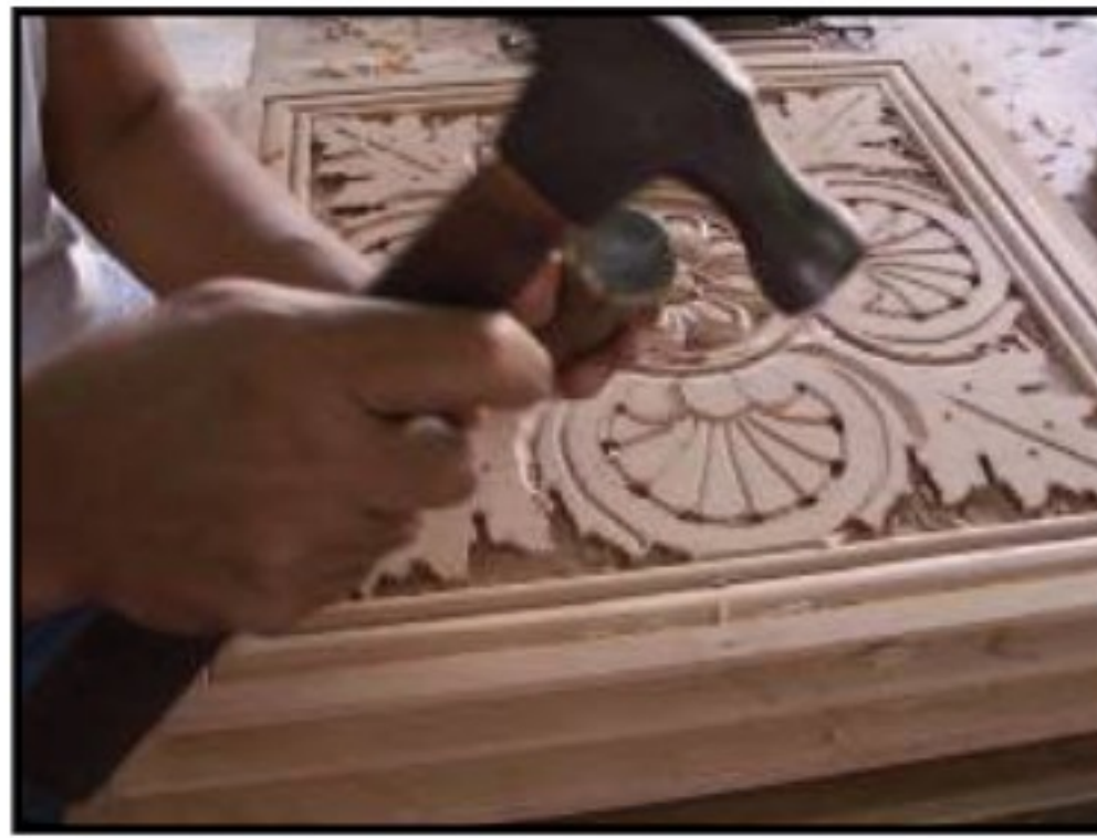
( ٢ ) : استخدام الجزء الجانبي للمطرقة ، وهي طريقة بديلة ، لكن الأفضل استخدام المدق الخشبي .
