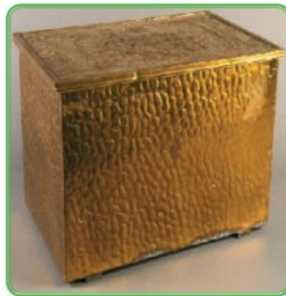
الشكل (٧٣): الطرق بالدق بالأزاميل.
