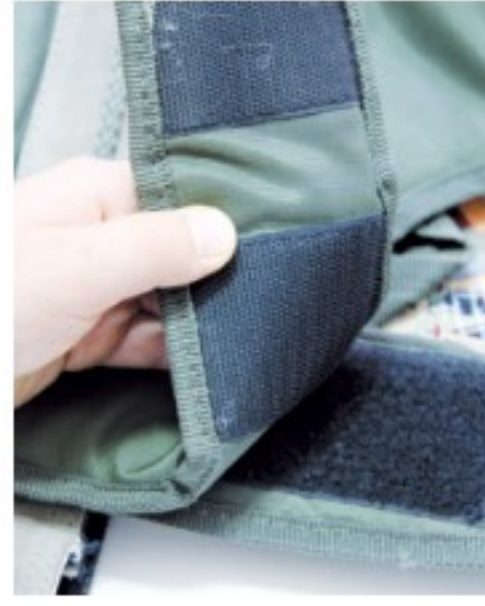
تستعمل ألياف النايلون في صناعة أشرطة التثبيت.
