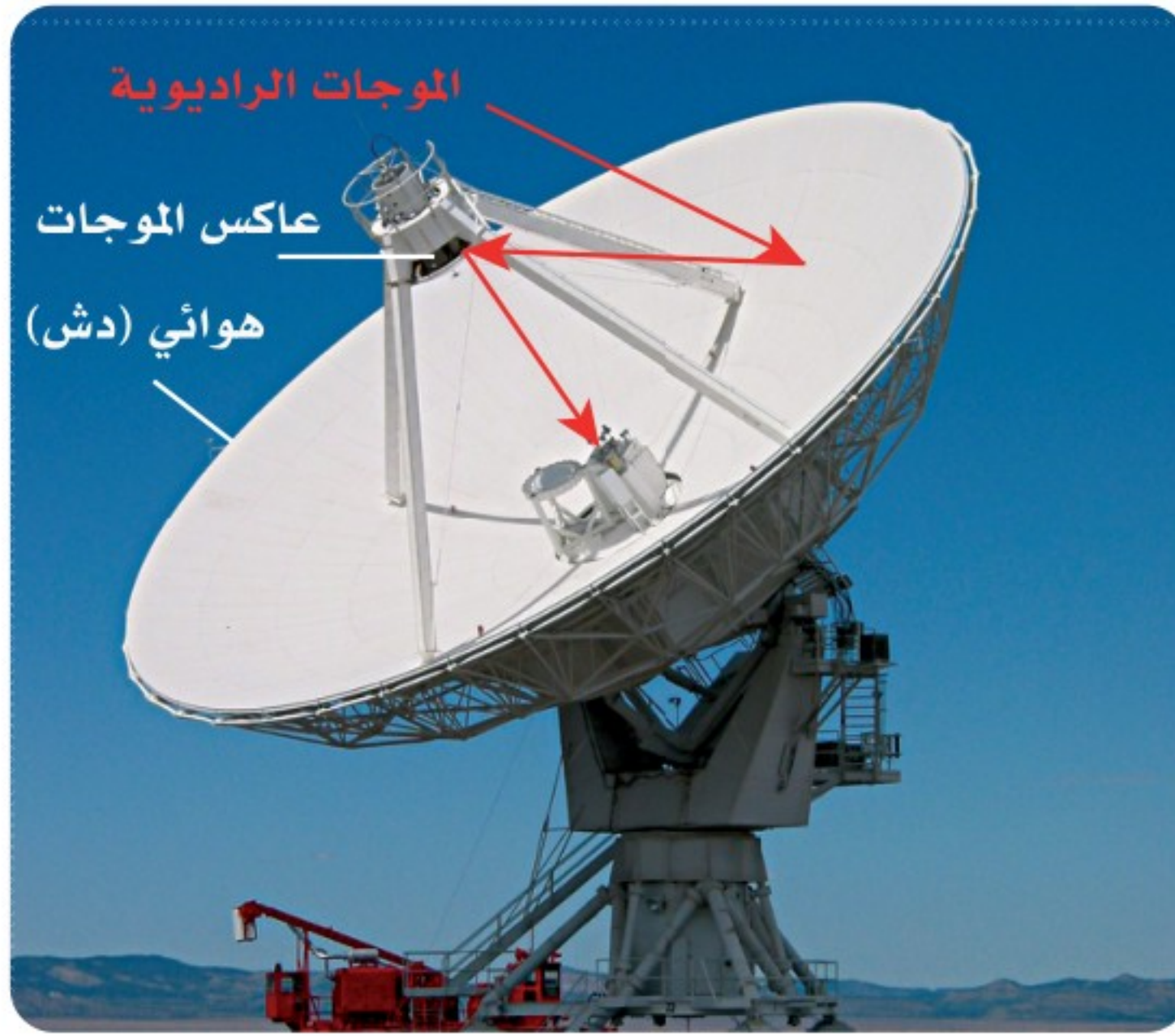
الشكل 14-3 تركيب المنظار الراديوي.
