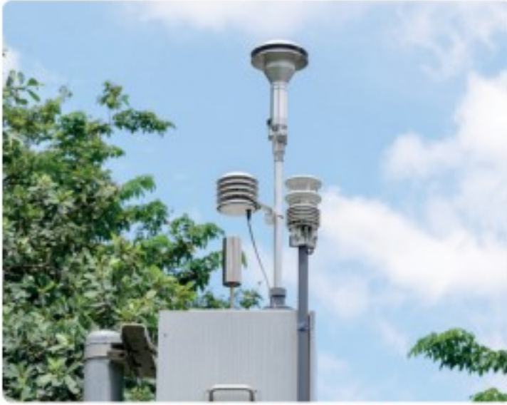
شكل 7.5: محطة جودة هواء ذكية
