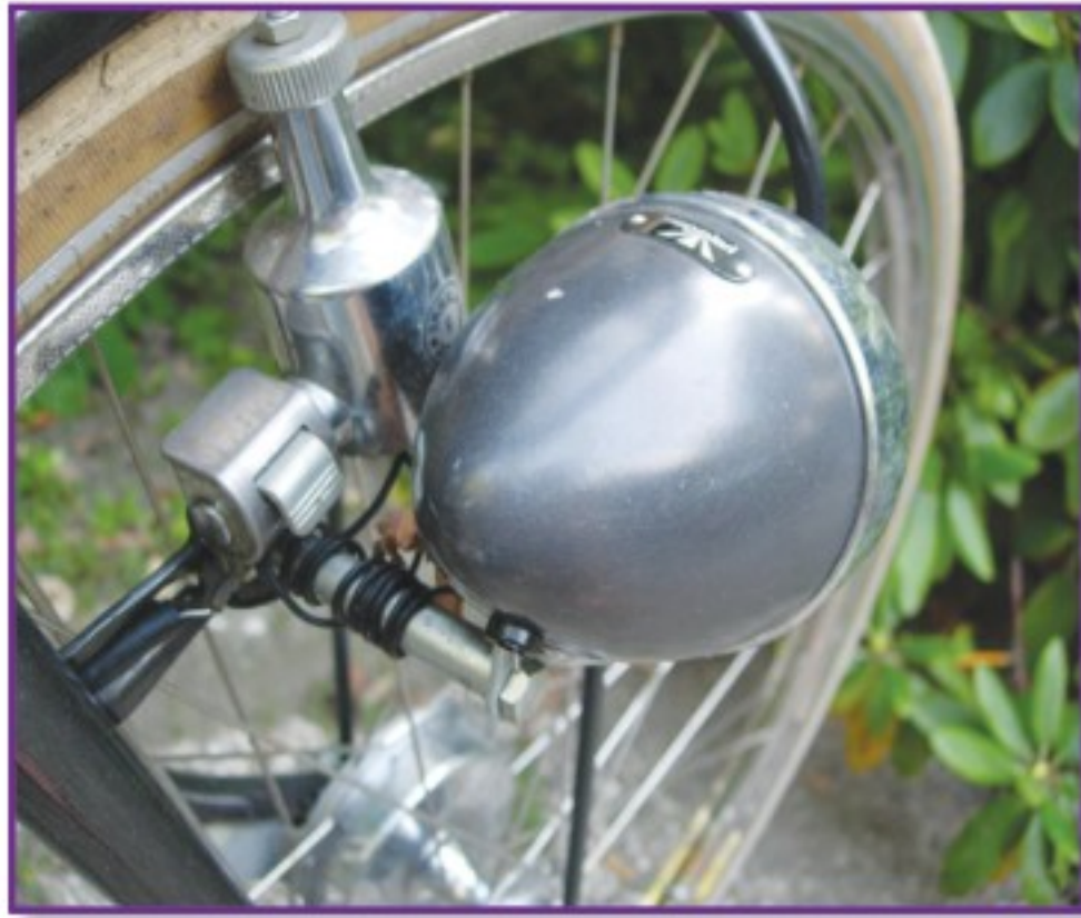
يتصل المولد الكهربائي بعجلة الدراجة
