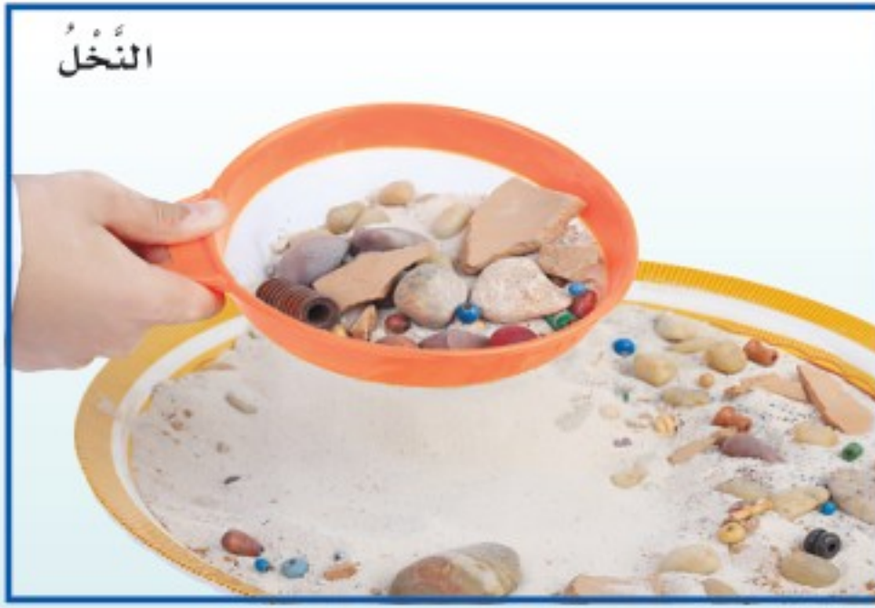
يستخدم المنخل لفصل مواد مختلفة الحجم.
