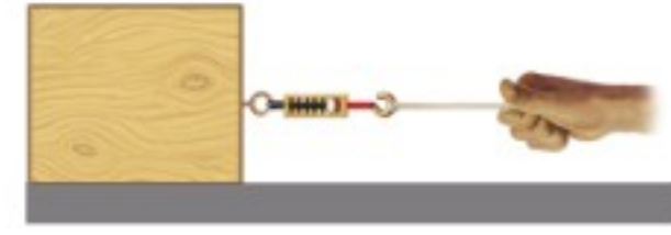
■ الشكل 9-5 يسحب الميزان النابضي الكتلة بقوة ثابتة.
