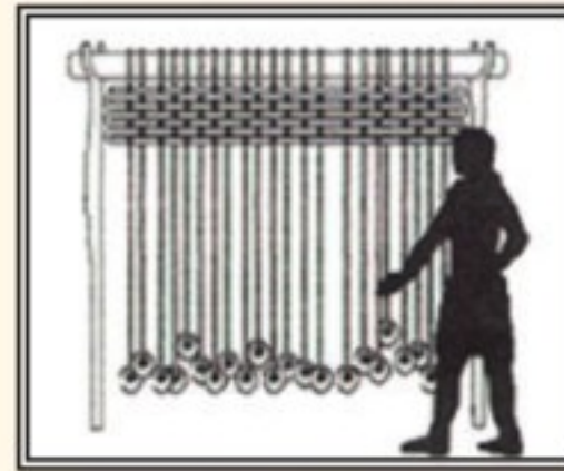
نول الأثقال أفقي، يوضع في نهايات السدى أوزان لتثبيتها في اتجاه واحد
