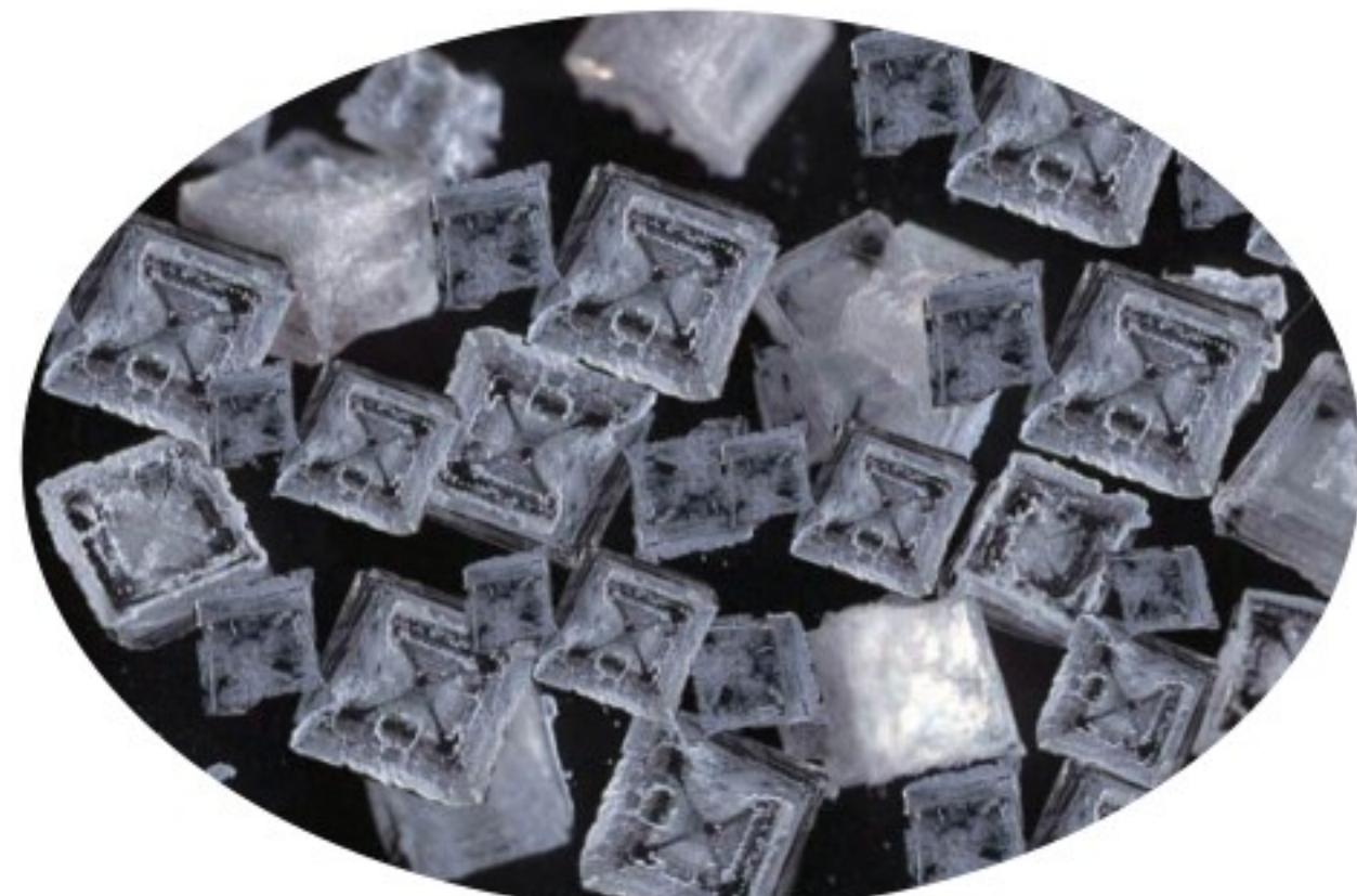
هذا الشكل المكبر يوضح الشكل المكعب للبلورات كلوريد الصوديوم
