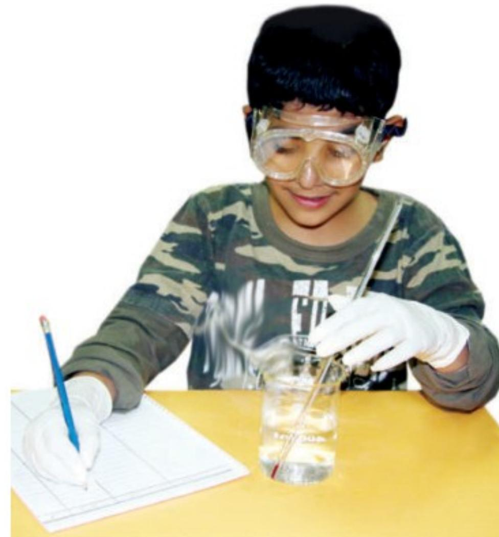
الشكل ١٤: يستخدم مقياس الحرارة لقياس درجة حرارة الأجسام. ومعظم مقاييس الحرارة في المختبرات عبارة عن أنبوب زجاجي في نهايته مسندود يحتوي على سائل مثل الكحول الملون. ويرتفع السائل في الأنابيب أو ينخفض كلما تغيرت درجة الحرارة. ولقراءة درجة الحرارة حرك المقياس الحراري بشكل دائري حتى تتمكن من مشاهدة السائل الملون، ثم ضع المقياس الحراري بشكل عمودي داخل الإناء بدون أن يلامس قاعه وأقرأ درجة الحرارة عند نهاية السائل.
