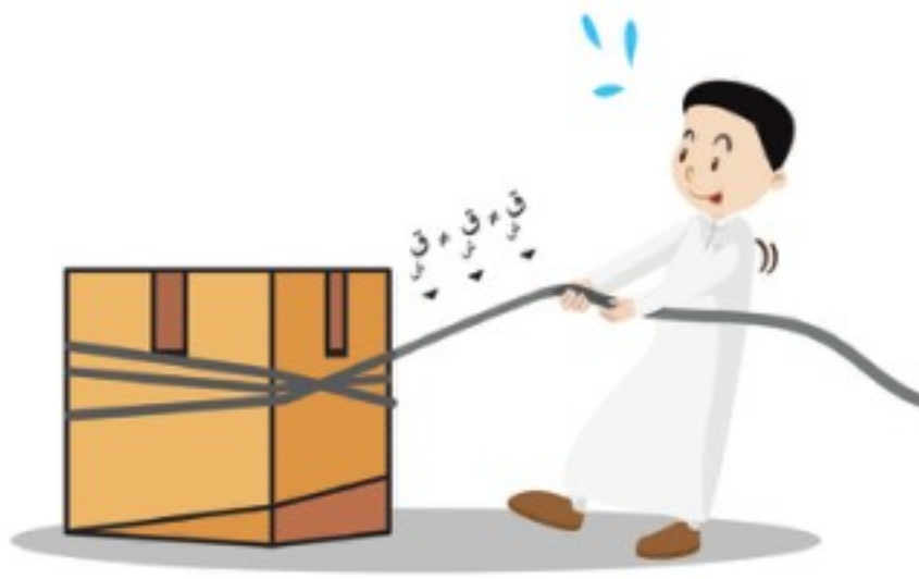
الشكل ١٥ عند عدم إهمال كتلة الحبل فإن قوة الشد غير متساوية في أجزاء الحبل.
