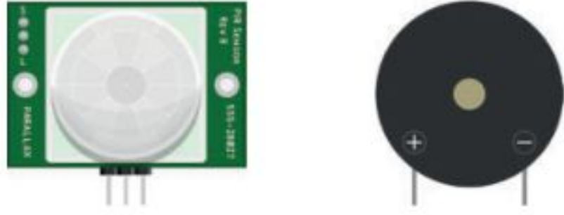
شكل 5.22: مُستشعر الحركة والطنان الكهربائي
