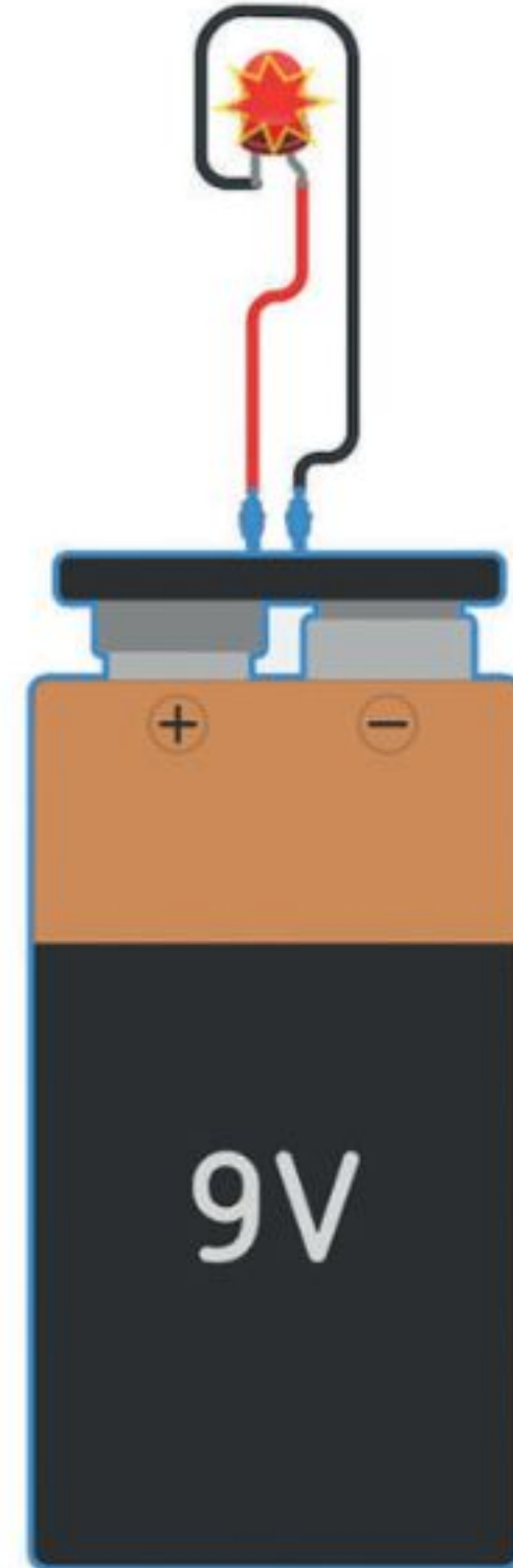
شكل 4.21: محاكاة مع وجود مشكلة في التيار في الدائرة
