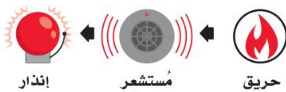
شكل 5.2: نظام إنذار الحريق
