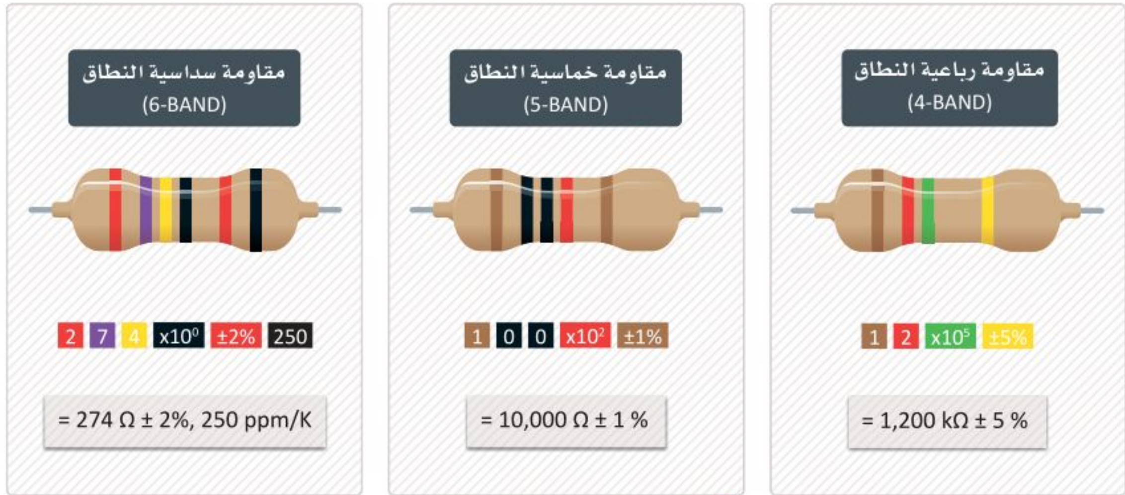
شكل 2.5: مثال على حساب قيمة المقاومة باستخدام الترميز اللوني
