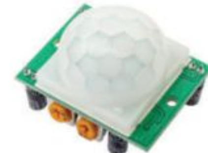
مُستشعر الحركة (PIR sensor)
