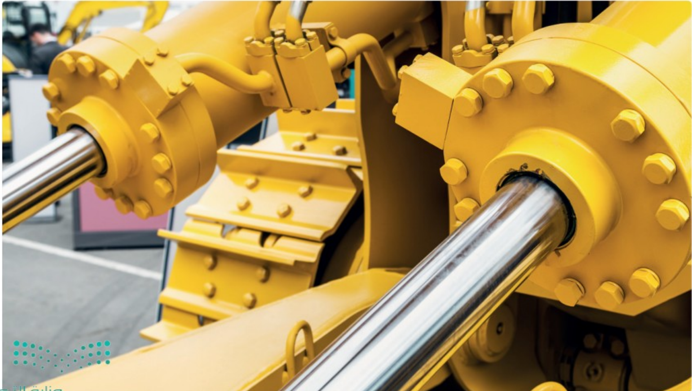
شكل 1.15: نظام مُشغل هيدروليكي (مكبس) للآلات الثقيلة
