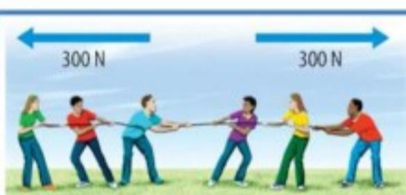
القوة المحصلة : قوة تعمل عمل مجموعه من القوى مقداراً واتجاهها، وتتساوي ناتج جمع المتجهات.
