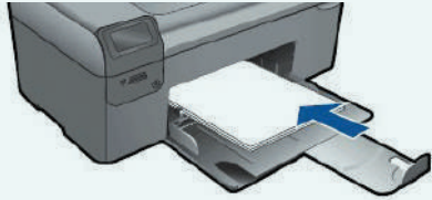
شكل (٤-٢-٢): تعبئة الطابعة بأوراق الطباعة
