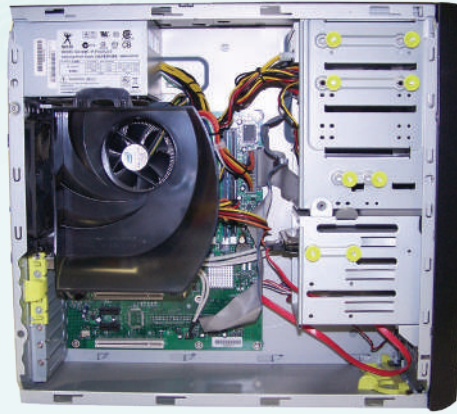
شكل (٤-٢): اللوحة الحاضنة داخل صندوق الحاسب
