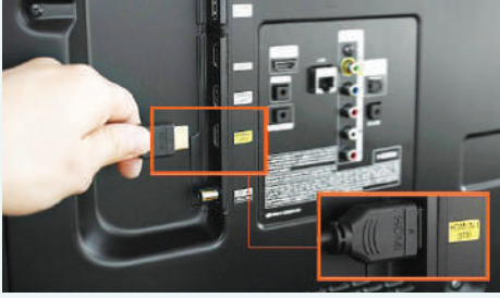
شكل (٢-٩): توصيل أحد طرفي سلك (HDMI) إلى منفذ (HDMI) على التلفاز
