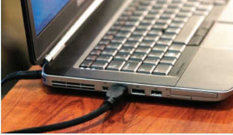
شكل (٢-١٠): توصيل أحد طرفي سلك (HDMI) إلى منفذ (HDMI) على جهاز الحاسب
